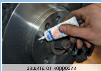
защита от коррозии
